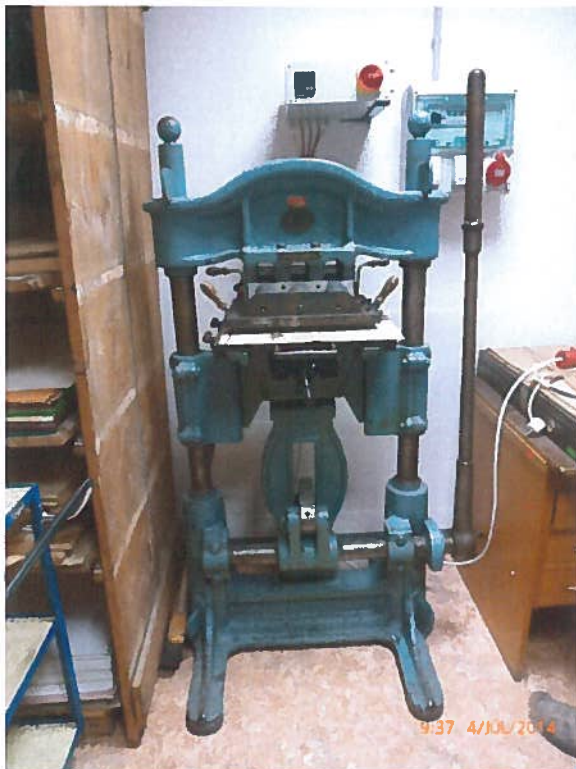
3-4. – a felújított Krause présaranyozó gép
